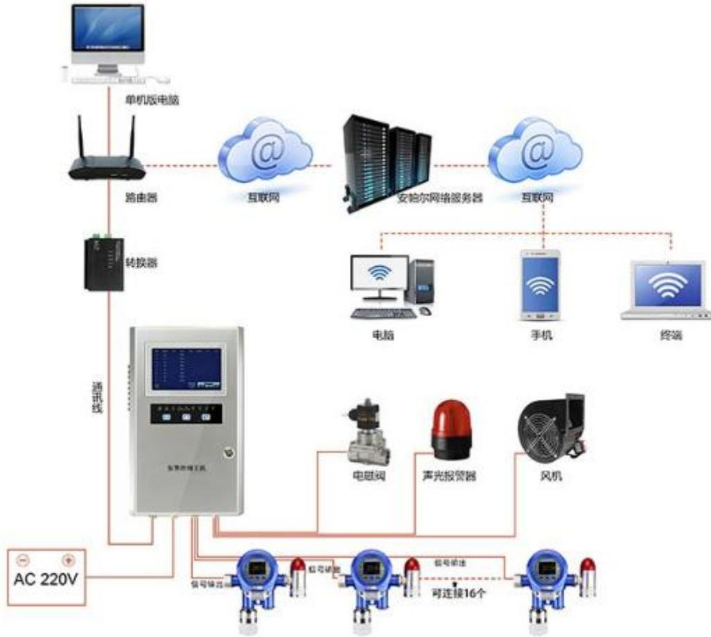
图 23 易燃易爆气体监测子系统逻辑图
